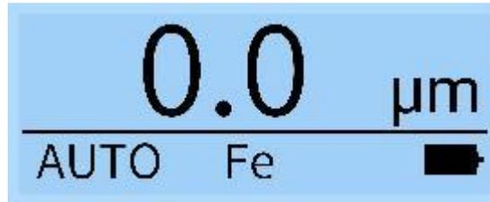
3.5 Nach Abschluss der Nulleinstellung legen Sie den Standardfilm auf die Platte (das Substrat) auf. Wenn der Messwert stabil ist und die Abweichung vom Standardwert innerhalb von  $\pm 3 \mu\text{m}$  liegt, kann das Messgerät ordnungsgemäß verwendet werden.
